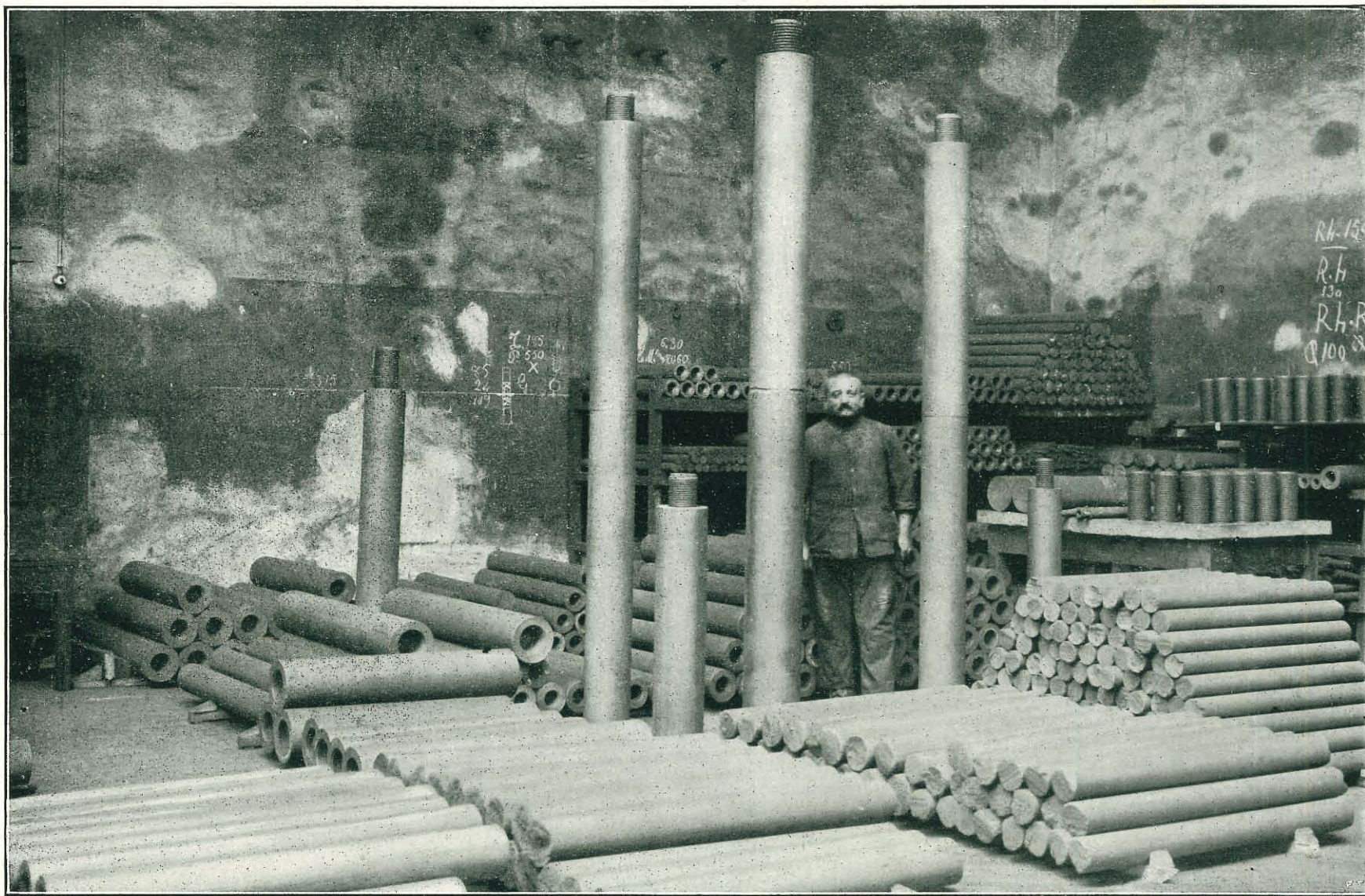
Elettrodi di grafite per forni elettrici. Il prodotto della Società, frutto di dieci anni di studi e sacrifici, va affermandosi, unico italiano contro colossi stranieri....
